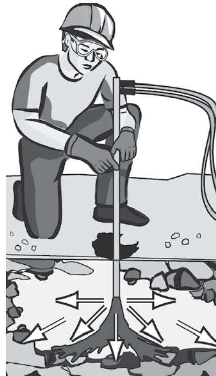
Figura 1: Estabilización de suelos
